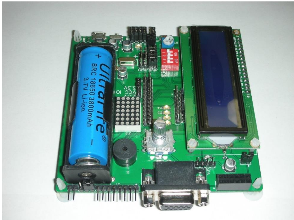
Figura 2. 6: Tarjeta de desarrollo FPGA Xilinx Spartan-3 XKF3.
