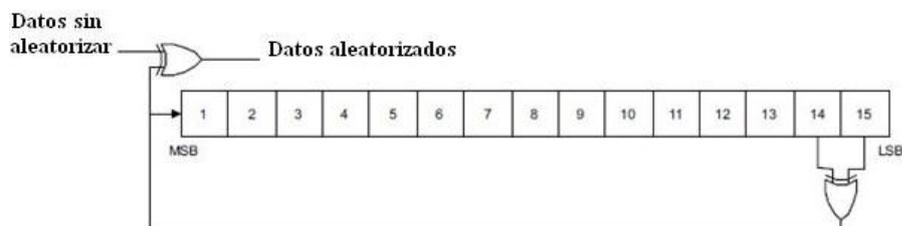
Figura 2. 2: Generador de secuencia binaria pseudoaleatoria para la aleatorización de los datos
