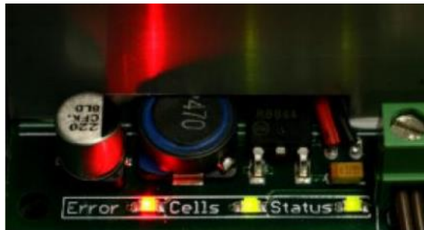
Figura 2. 20: Indicadores LED de la tarjeta Sabertooth 2x60 Elaborado por: Autores
