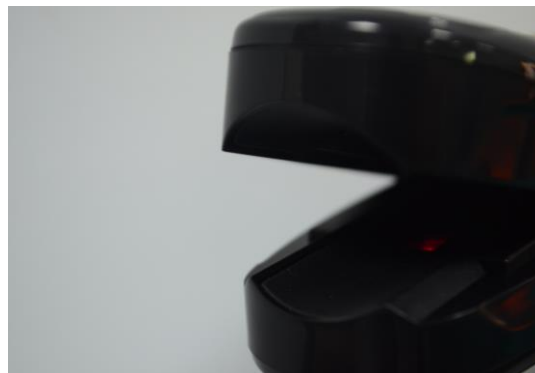
FIGURA N° 23 Se observa la luz roja que estará en contacto con la piel del dedo
