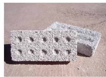
Fig. 3: Ladrillos de PET y cemento.
