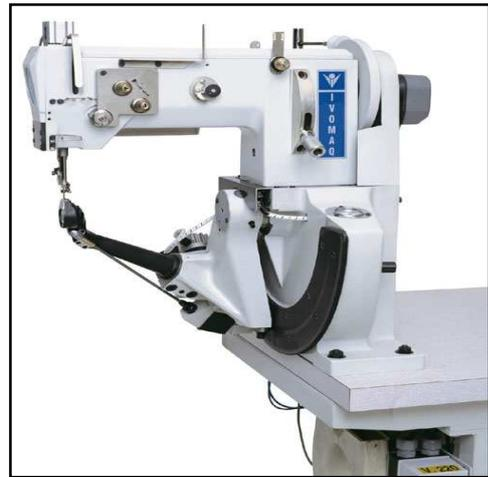
Brazo oscilante con movimiento manual o eléctrico por pedal, permitiendo costura en las partes menos accesibles del zapato. Transporte doble (pie transportador y aguja), para la igualdad de las puntadas.
