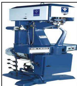
Máquina de costurar suelas con 02 hilos ("Blaqueadeira"), lanzadera grande, extractor de bobina neumática, limpiador de lanzadera dirigida. Ejecuta costuras en suelas de caucho natural, sintético, cubiertas, cueros. Cambiando el yunque ejecuta costura en las laterales de las zapatillas (Opanke).
