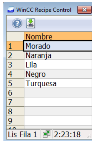
Figura 2. 1: Selección de receta para arranque de trabajo. De no hacerlo presentara falla.
