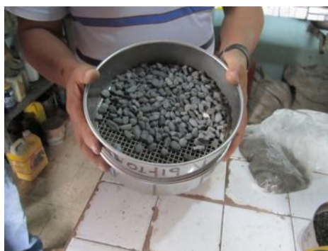
Foto 23. Tamizado árido grueso
