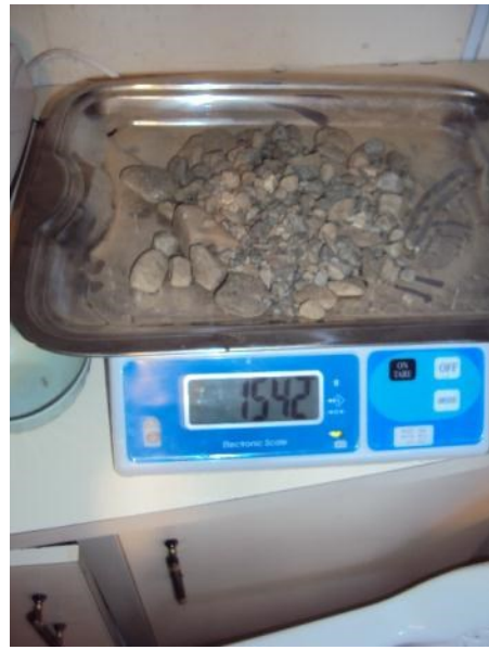
Foto 6. Retenido 3,2mm agregado grueso 82,14%.
