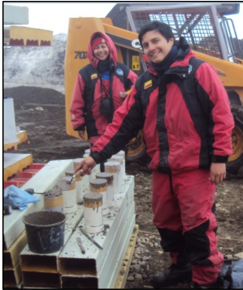
Foto 29. Toma de Muestras de Hormigón
