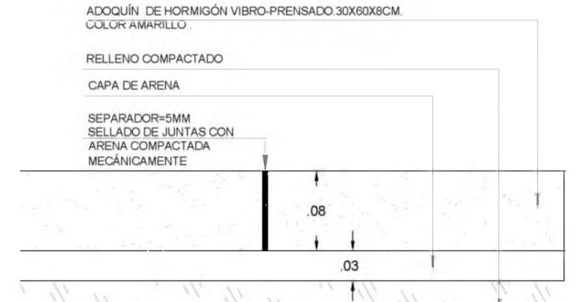
**DETALLE DE UNIÓN ENTRE ADOQUINES**
