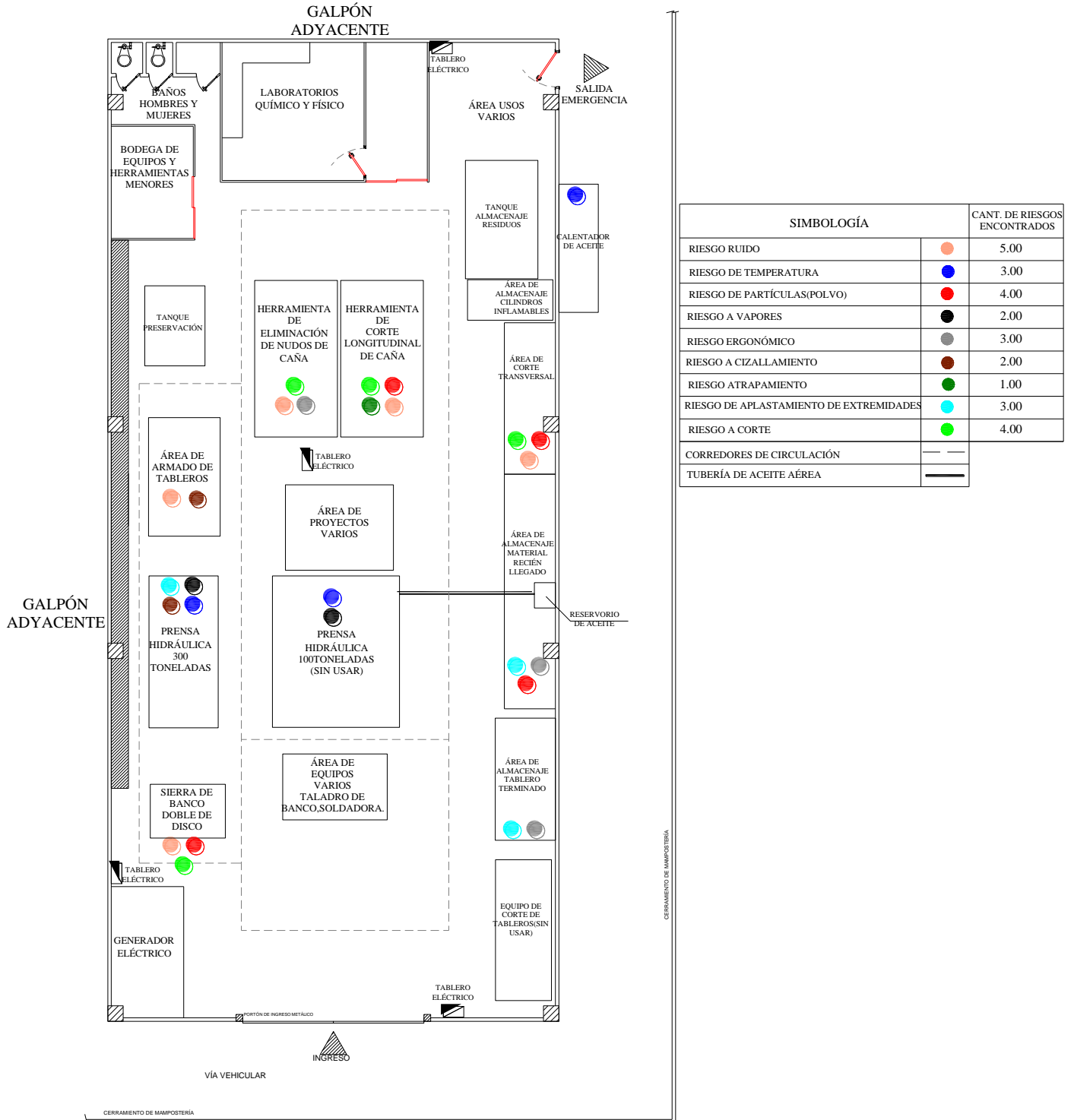
Figura 49.-Identificación de riesgos en procesos de trabajo en Planta de Ecomateriales.
