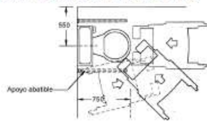
FIGURA 9. Localización del inodoro. (Dimensiones en mm)
