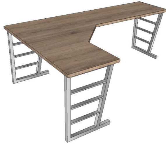
Figura 98: mesa con diseño esquinero en L para la sala de profesores Fuente: elaboración propia
