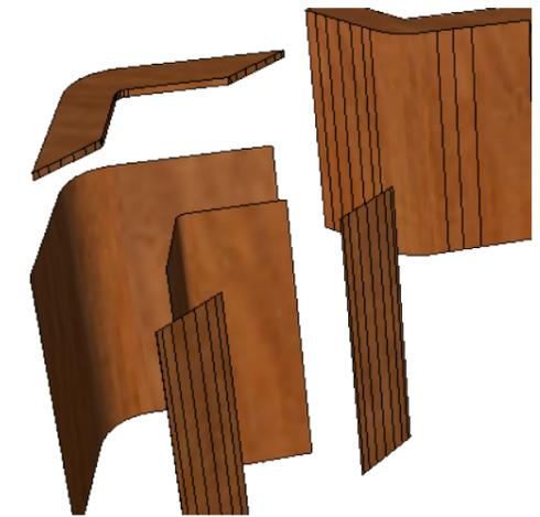
Estructura de roble formando el contorno del logo del MAAC el cual será revestido de MDF de 3mm de espesor.
