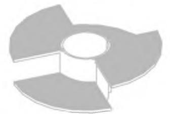
ANCLAJE DE LA ESTRUCTURA METÁLICA CON EL BLOQUE PERNO DE 3PULG
