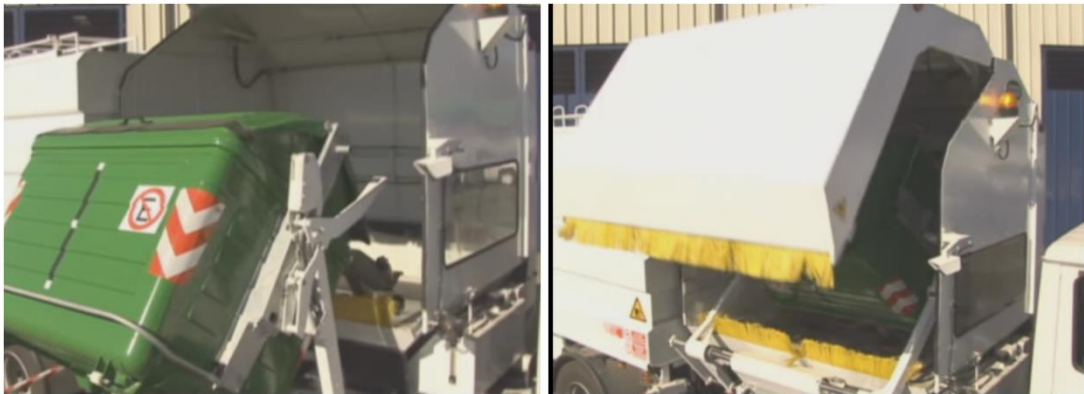
Figura 19. Operación Lava Contenedor Fase 2
