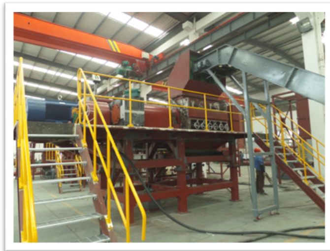
Ilustración 22 TRITURADORA PRIMARIA EN SISTEMA DE RECICLAJE
