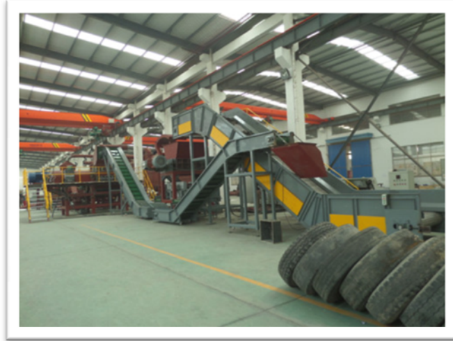
Ilustración 21 Destanroladora en sistema de reciclaje
