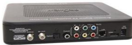
Figura 35. Interfaces del Se Top Box con soporte Ginga-NCL
