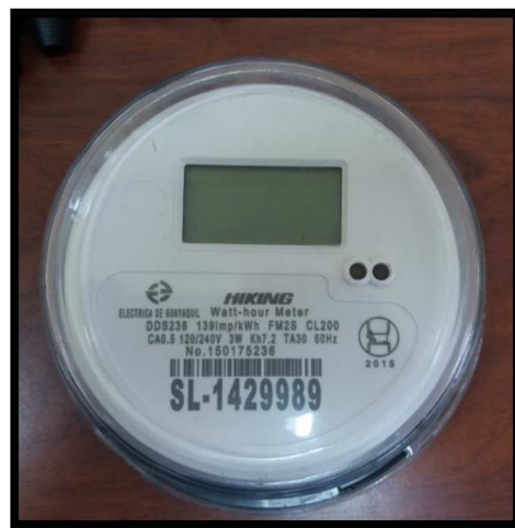
Fig.23 Medidor monofásico 3 hilo tipo SL
