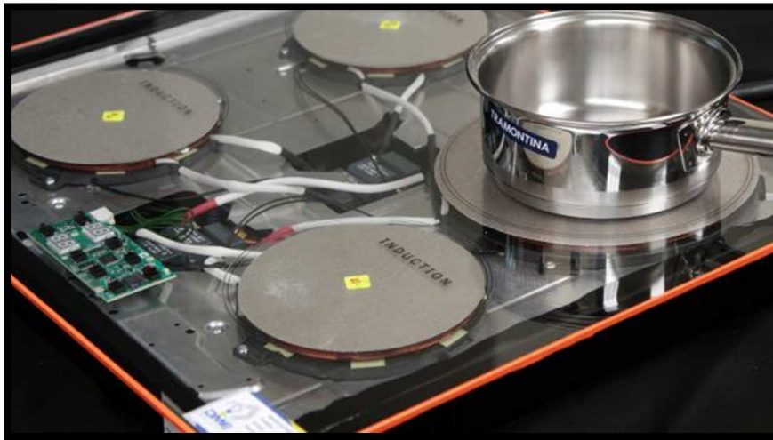
Fig.25 Aspecto interior de cocina de inducción
