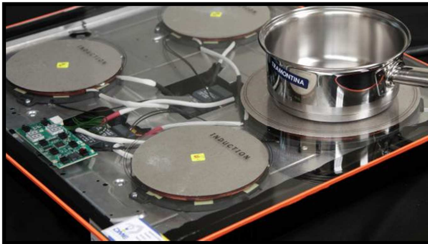
Fig.25 Aspecto interior de cocina de inducción
