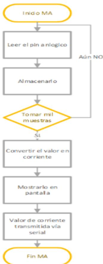
**Figura 4.4** Diagrama de flujo de modo ACS712 MA
