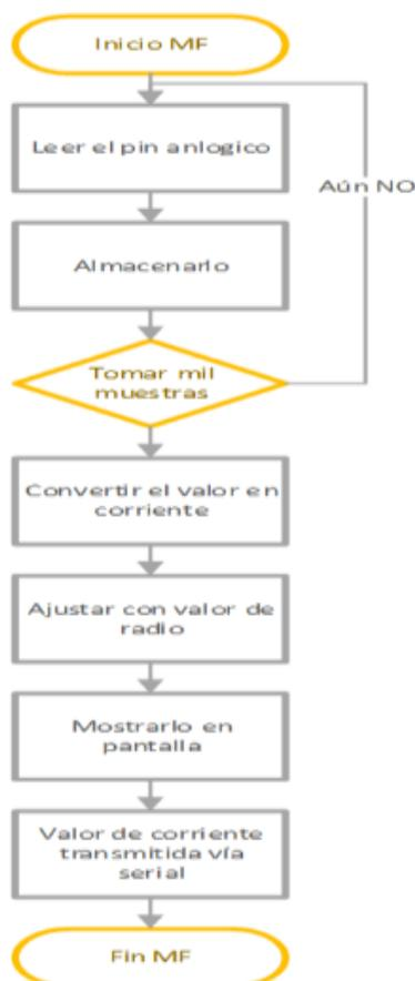
**Figura 4.5** Diagrama de flujo de modo FHS\_40P/SP600
