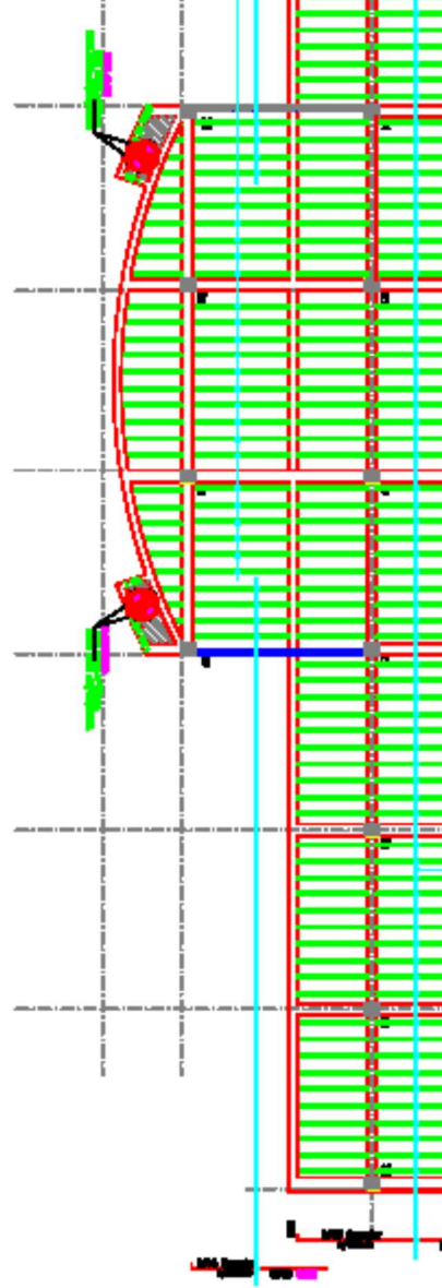
DETALLE TIPO DE VIGETA TRAPEZOIDAL LONGITUDES MAX L=400mm.(N°1)
