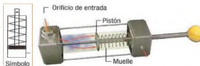
Figura 4. Cilindro simple efecto y su símbolo
