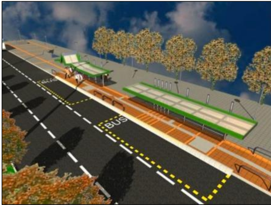
Figura 6.5 Ejemplo de un paradero de bus con implementos de seguridad completos
