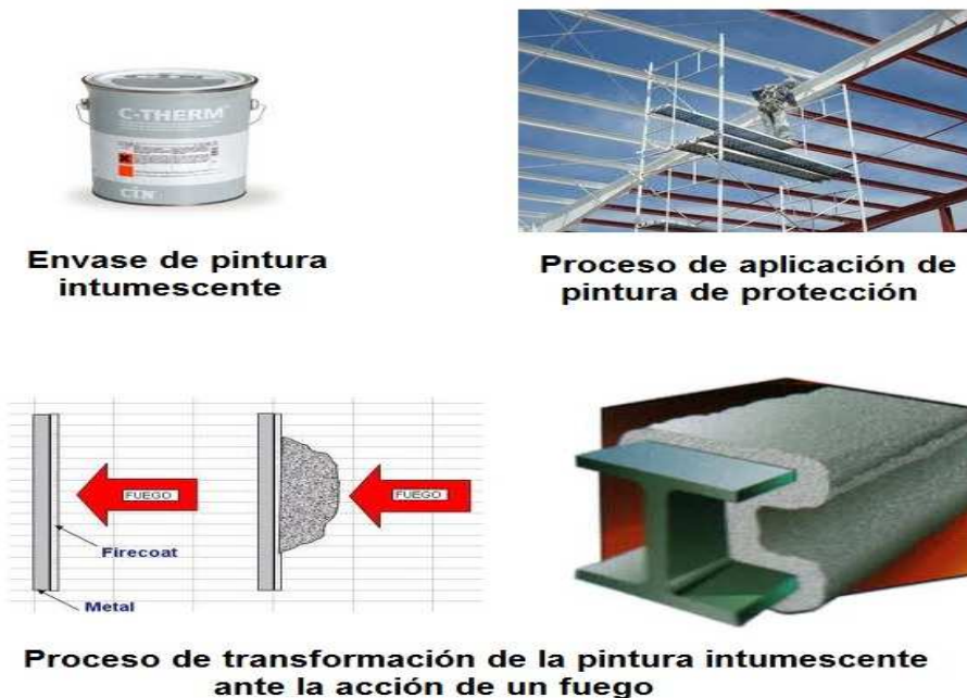
Figura 43: Protección mediante pinturas intumescentes
