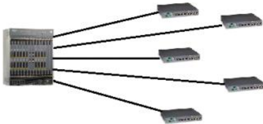
Figura 2. 9: Conexión punto a punto. Fuente: (Marchukov, 2011)
