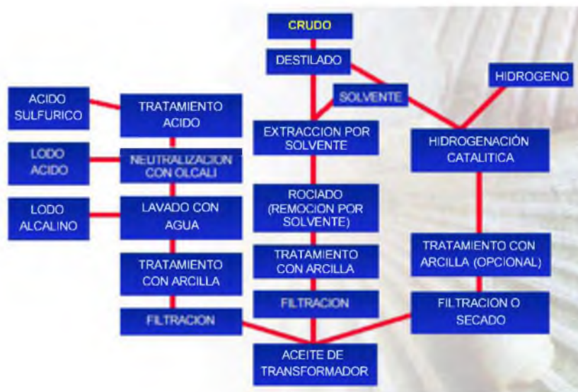
Figura 3.30: Proceso de fabricación del aceite dieléctrico. Fuente: (Gil Alonso, 2009)
