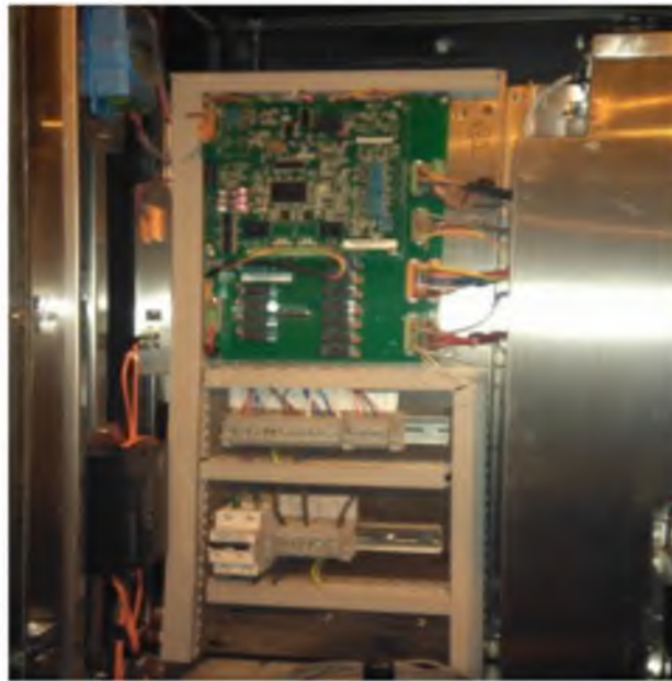
Anexo 1.9 Vista frontal del equipo TROM-600 (con la puerta abierta), en donde se puede observar el panel de control y la tarjeta madre del sistema.
