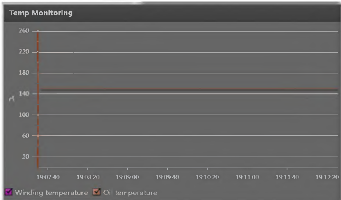
Anexo 2.18 Interfaz de visualización gráfica del control de la temperatura del aceite y del devanado en el transformador de potencia de la Subestación Durán-Norte.
