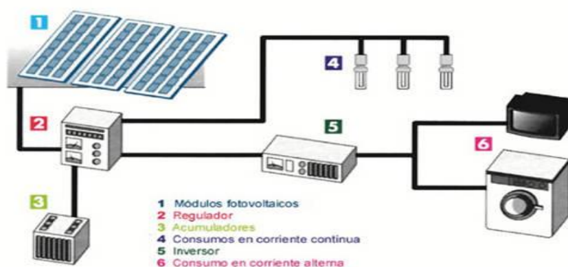
Figura 5 Esquema de Instalación Fotovoltaica
