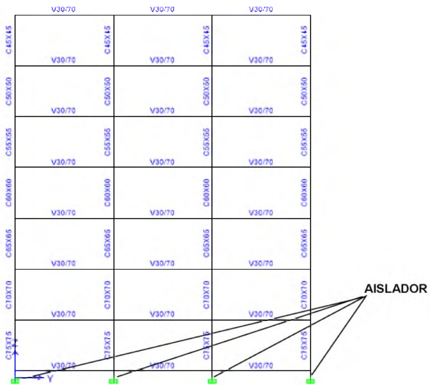
Figura 2.8. Ubicación de Aisladores de Base en el Modelo
