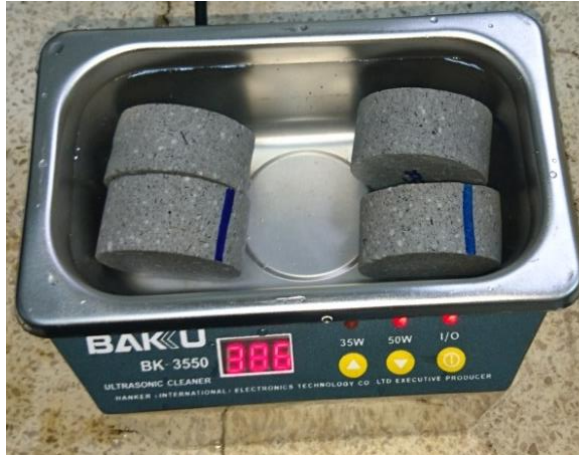
Anexo 9: Lavado de pastillas en limpiador ultrasónico
