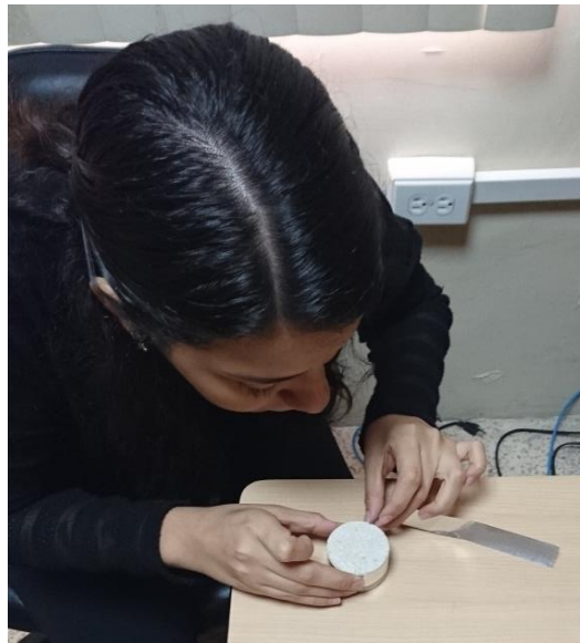
Anexo 10: Proceso de recubrir pastillas con papel aluminio
