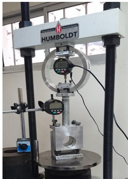
Figura 3.16: Ensayo de la muestra Fuente: Fotografía de los autores
