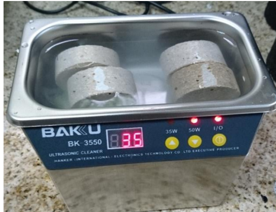
Figura 3.5: Lavado con limpiador ultrasónico
