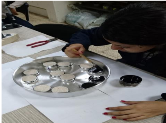
Figura 3.9: Pintado de las pastillas
