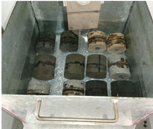
Figura 5.6: Muestras en baño en agua a 10°C en el NAT Fuente: Fotografía de los autores
