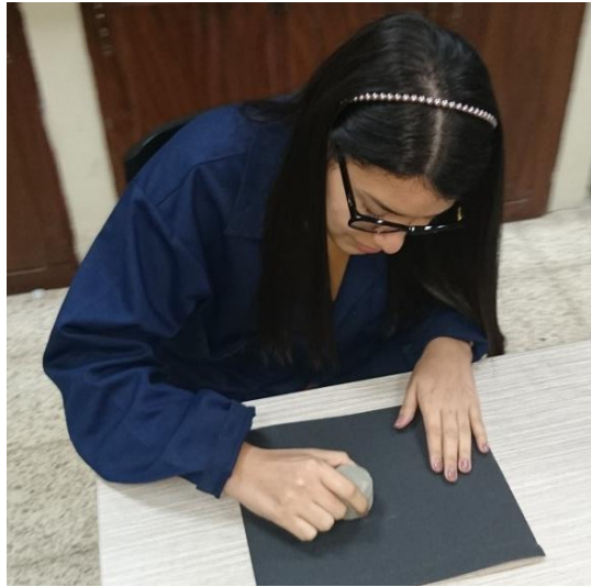
Figura 3.3: Lijado de pastillas de roca
