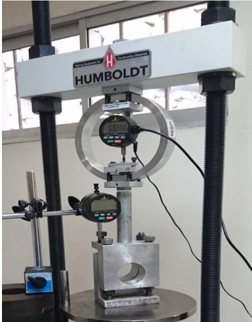
Anexo 22: Ensayo de corte a muestra (caliza)
