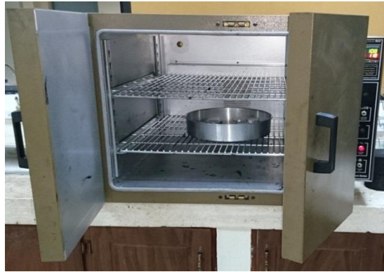
Figura 3.7: Proceso de secado de las pastillas en el horno Fuente: Fotografía de los autores
