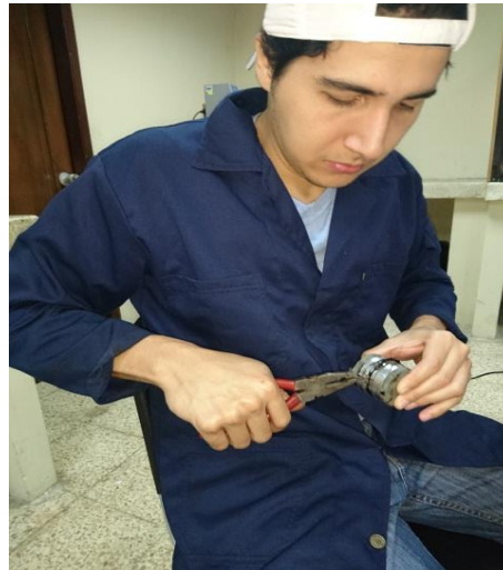
Figura 3.13: Retiro del alambre y papel aluminio
