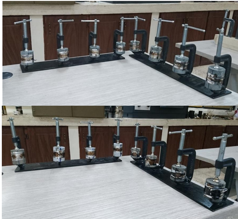
Anexo 17: Muestras (sándwiches) en las prensas mecánicas
