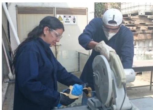
Figura 3.2: Proceso de corte de núcleos
