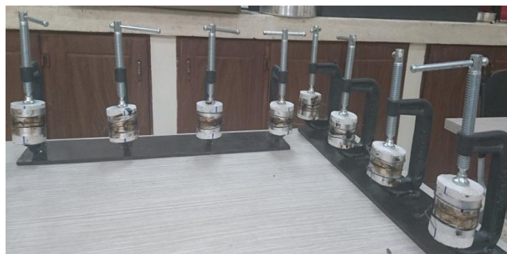
Figura 3.12: Sándwiches de roca en las prensas mecánicas Fuente: Fotografía de los autores
