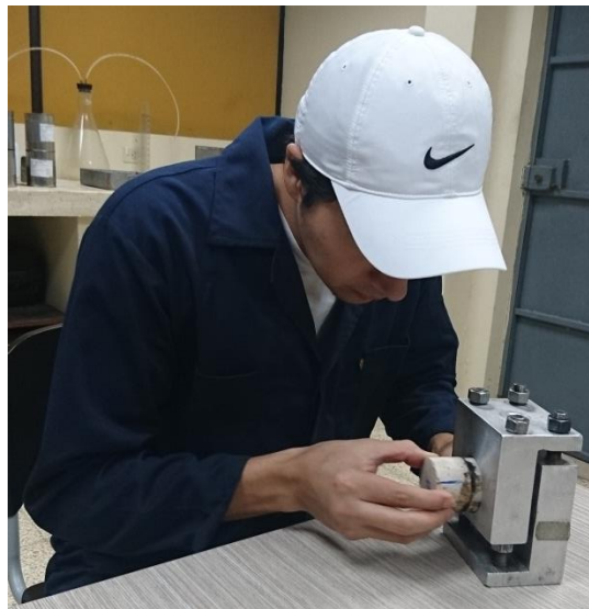
Anexo 21: Colocación de la muestra dentro de la máquina de corte
