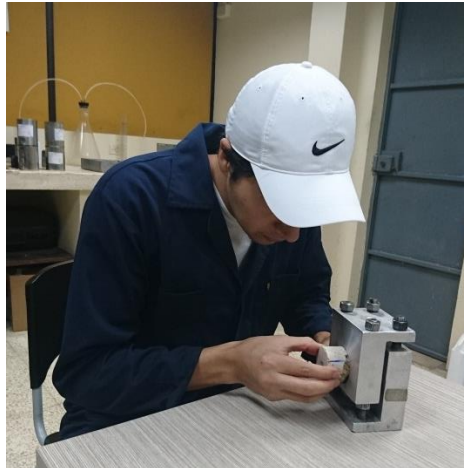
Figura 3.15: Muestra en el equipo de corte Fuente: Fotografía de los autores
