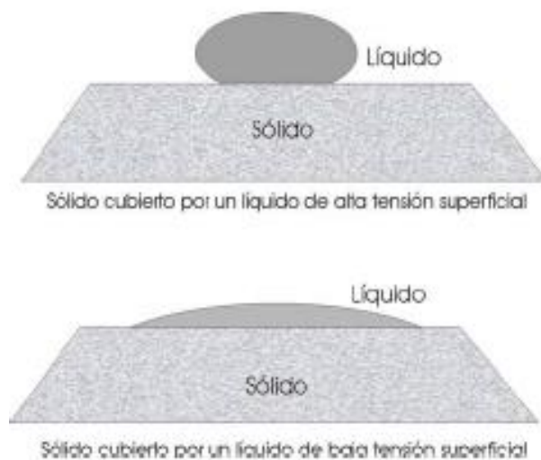
Figura 2.8: Representación esquemática de la influencia de la tensión superficial sobre el cubrimiento producido por un líquido.
