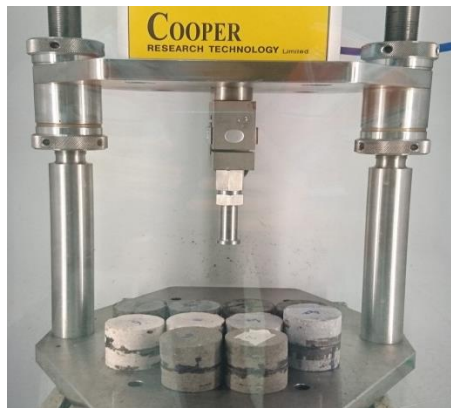
Figura 5.4: Muestras en el NAT Fuente: Fotografía de los autores
