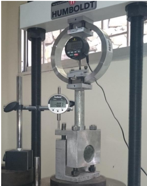
Anexo 23: Ensayo de corte a muestra (basalto)
