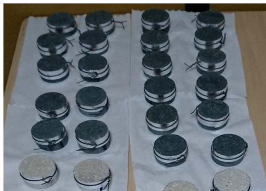
Figura 3.6: Pastillas cubiertas con papel aluminio
