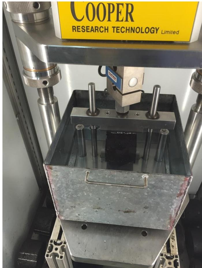
**Figura 2.27. Ensayo de fatiga en equipo NAT con inmersión**
