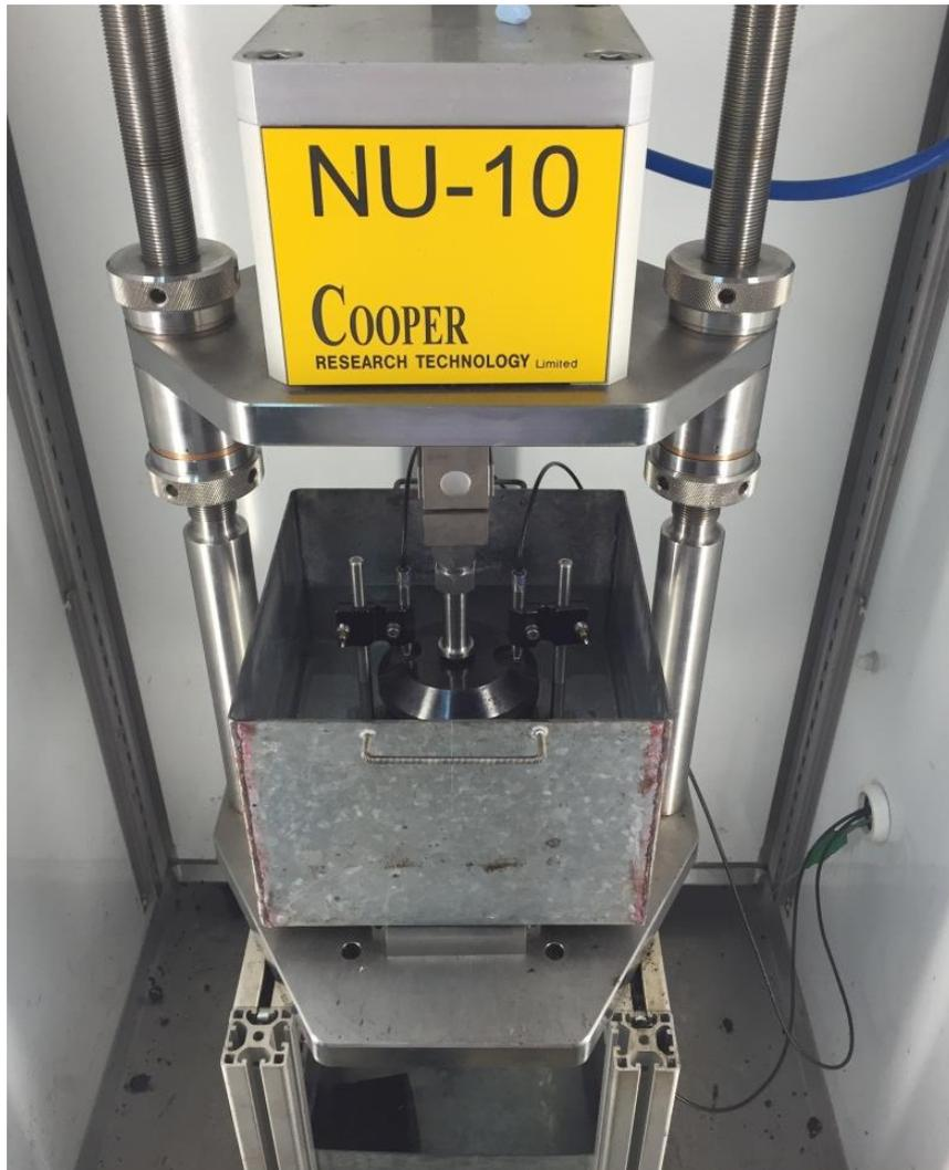
**Figura 2.29. Ensayo de deformación bajo compresión cíclica en equipo NAT con inmersión**
