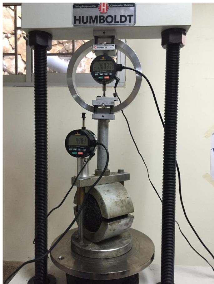
**Figura 2.20. Ensayo de estabilidad Marshall**
