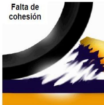
**Figura 2.9. Pérdida de cohesión del mástico asfáltico**
