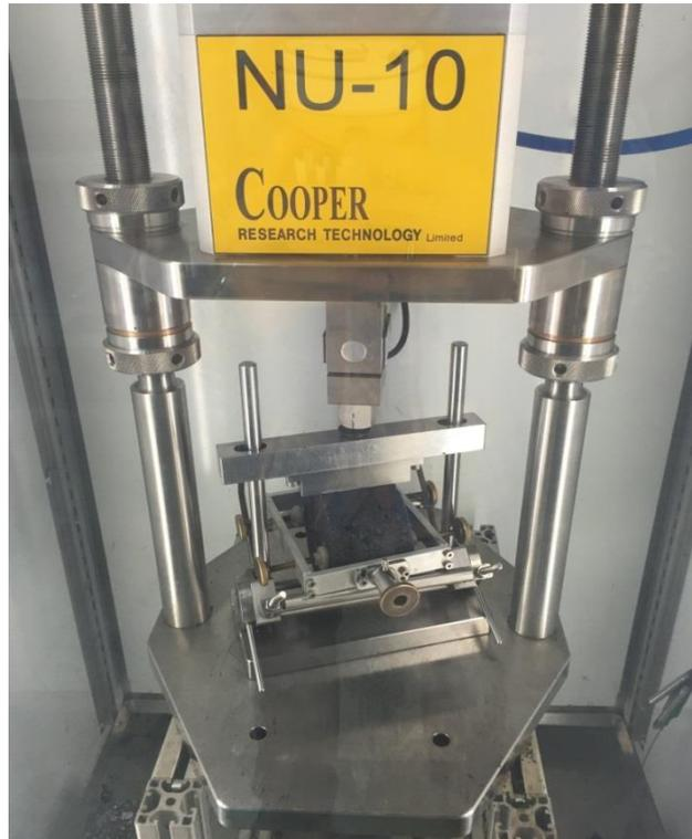
**Figura 2.21. Ensayo de módulo de rigidez con equipo NAT**
