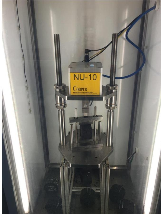
**Figura 2.25. Ensayo de fatiga con equipo NAT**
