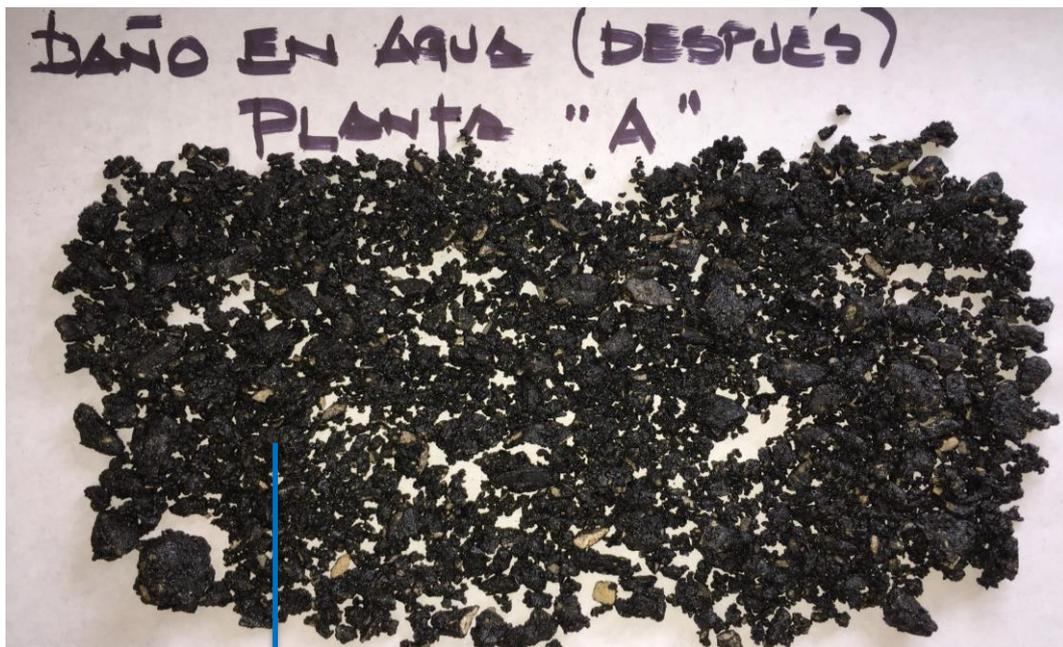
Figura 3.1. Daño en agua. Planta A
