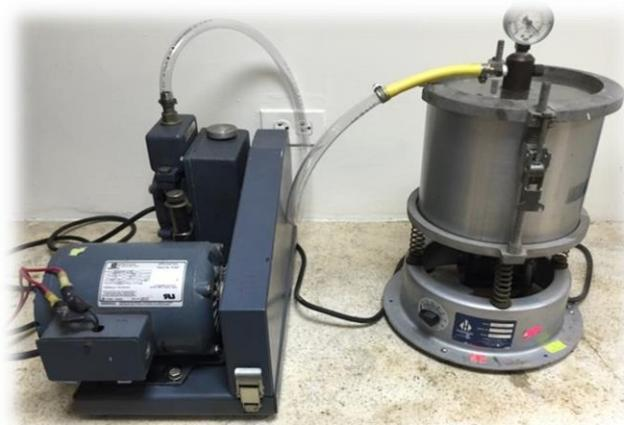
**Figura 2.16. Picnómetro y bomba de vacíos**
