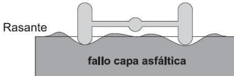
**Figura 2.7. Ahuellamiento por falla de la mezcla asfáltica**
