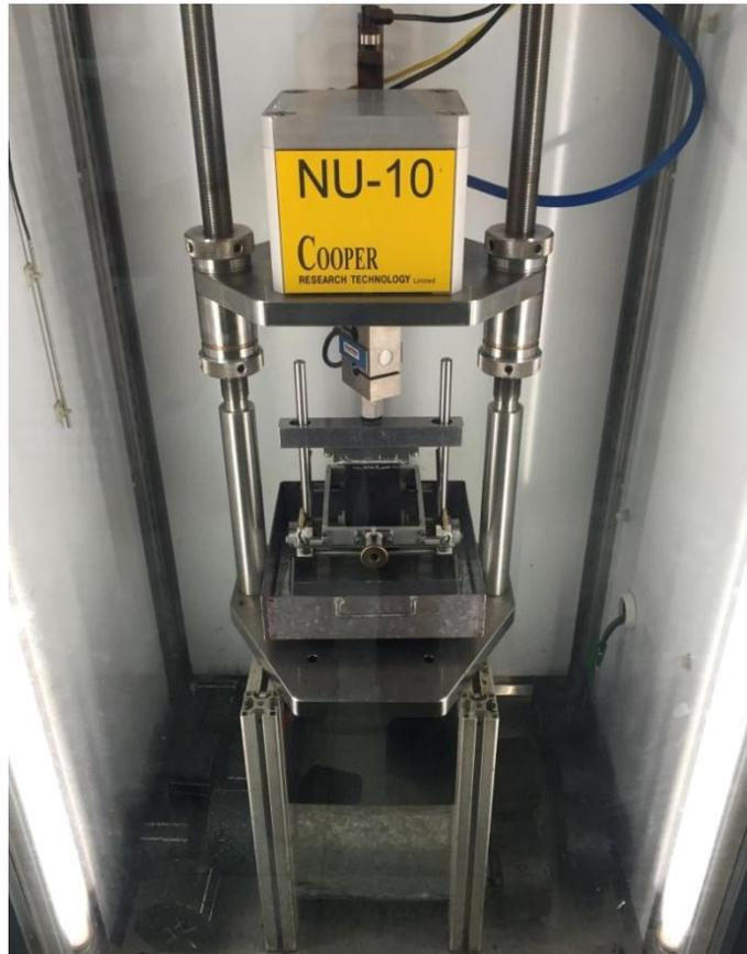
**Figura 2.22. Ensayo de módulo de rigidez en equipo NAT con inmersión**
