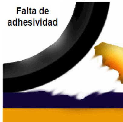
**Figura 2.8. Fallas en la adherencia entre el agregado y asfalto**
