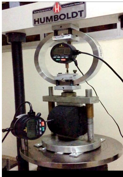
**Figura 2.19. Ensayo de tracción indirecta**
