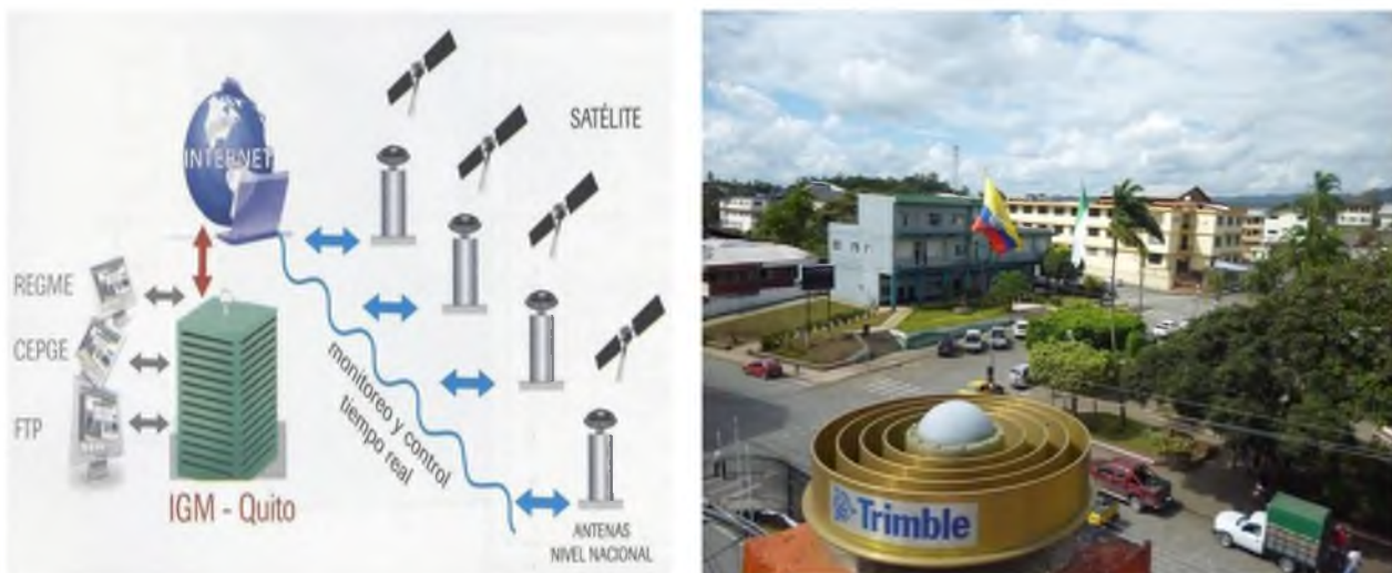
Figura 18 Esquema de funcionamiento de la REGME
