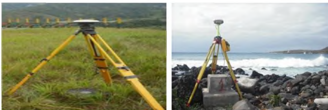
Figura 16 Mojones de concreto que conforman la RENAGE
