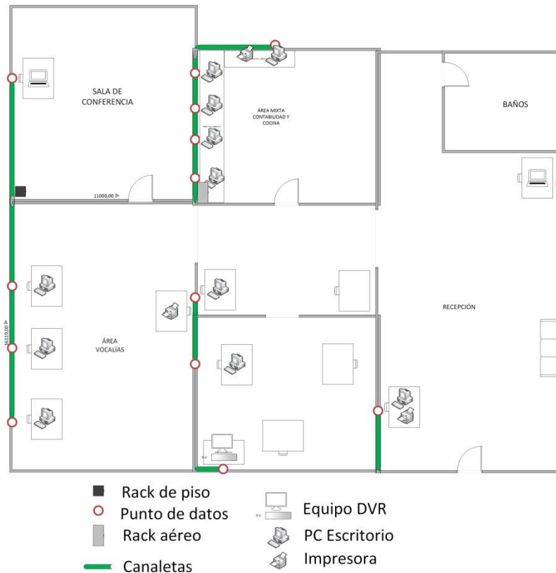
Figura 16: Propuesta de cableado estructurado
