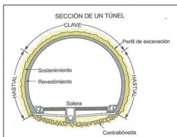
Figura 2.1. Elementos constitutivos de un túnel.
