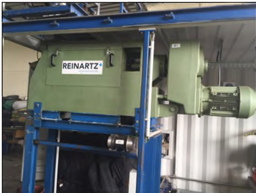
Extractor de Aceite de Piñon Marca Reinartz
