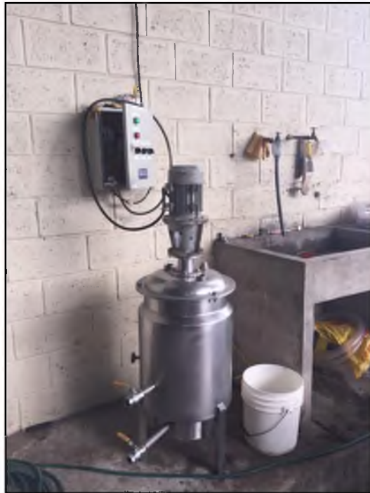
Elaboradora de Biodiesel a base de piñón
