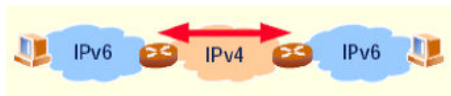
Figura 3. 3: Esquema del mecanismo Router to Router. Fuente: J. Coellar y J. Cedeño.
