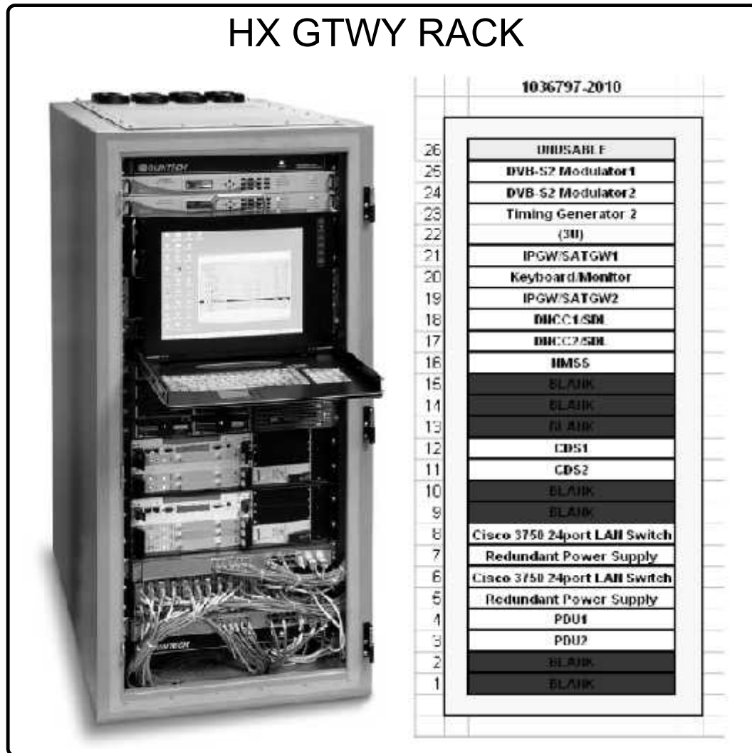
Figura 4. 12Rack Gateway HX Fuente: Manual Arquitectura del Sistema HX
