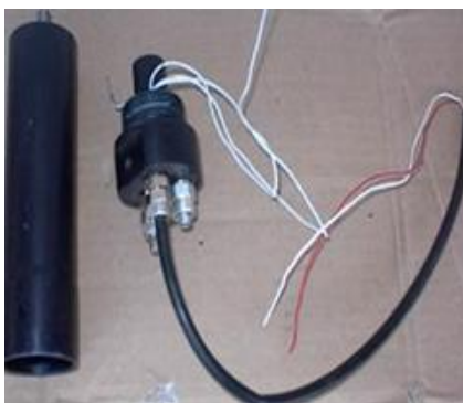
Figura 4. 7: Colectores o Housing MB para TP 204M Fuente: Cortesía ETECSA.
