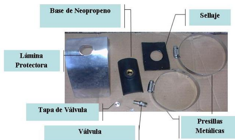
Figura 4. 3: Módulo para válvula de prueba. Fuente: Cortesía ETECSA.
