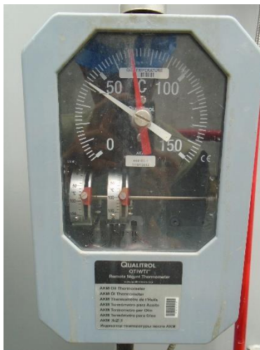
Figura 2.7 Indicador de Temperatura OTI – SERIE Fuente: Autor
