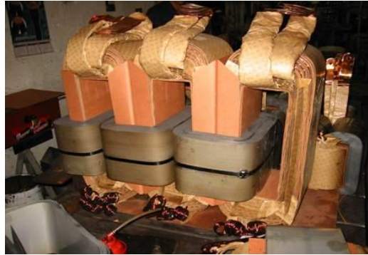
Figura 2.4 Parte interna de un transformador. Fuente: http://www.rymelcr.net/Normas.html
