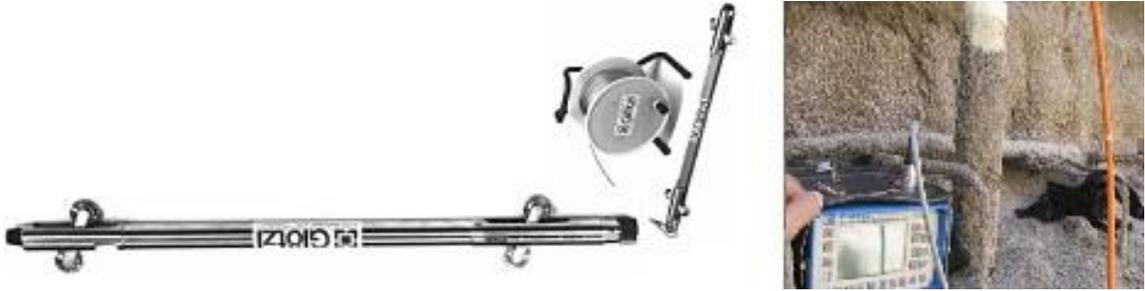
**Fig. 4. 40 Inclinómetro con sus componentes**
