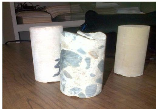
**Fig. 4. 13 Núcleos de hormigón**
