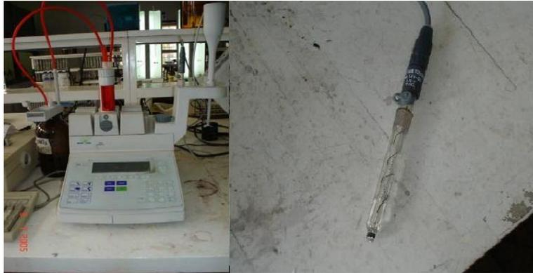
**Fig. 4. 30 Potenciometrico y electrodo de ión, equipo para realizar el contenido de cloro en el hormigón**
