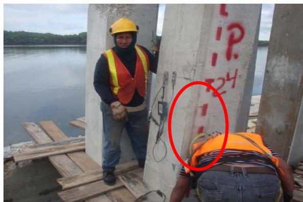
**Fig. 5. 14 En la que se muestra la instrumentación del pilote a ser ensayado**
