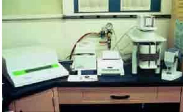
**Fig. 4. 33 Análisis térmico del hormigón**
