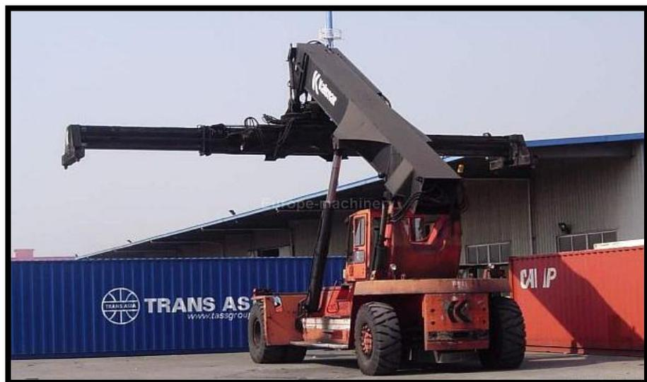
**Fig. 1. 7 Maquina Reach-Stacker en operación**
