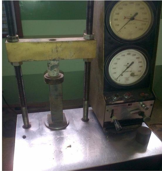
**Fig. 4. 29 Ensayo de compresión al corazón endurecido
