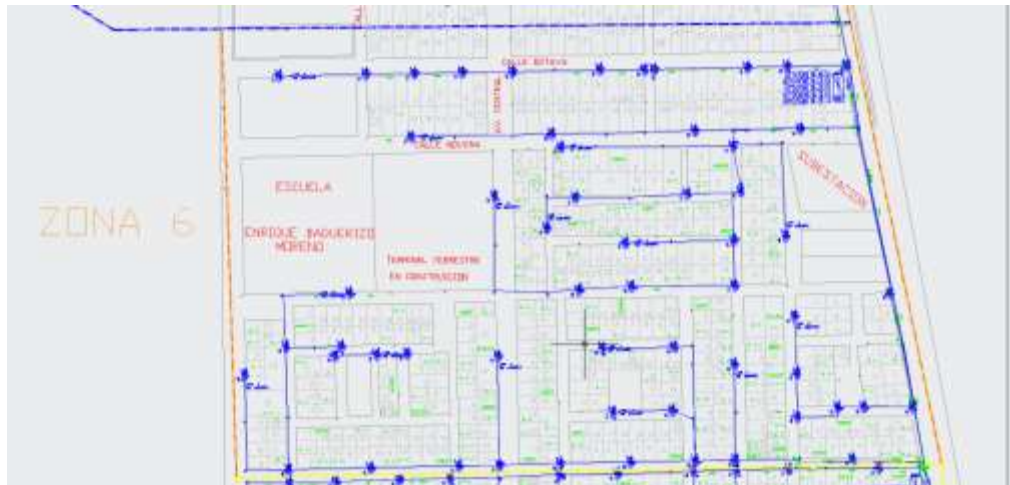
Figura No. 3.18 Distribución de las cajas NAP en la zona 6 Elaborada por el autor
