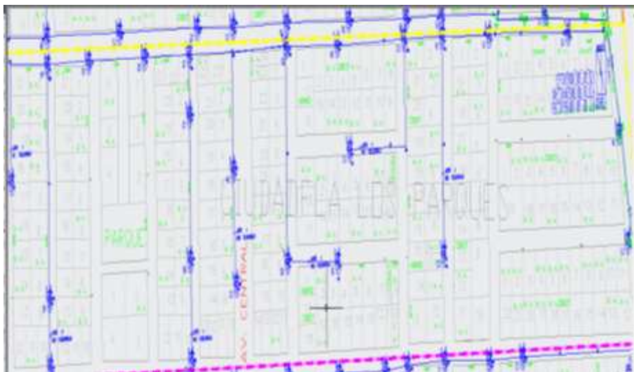
Figura No.3.17: Distribución de las cajas NAP en la zona 5 Elaborada por el autor
