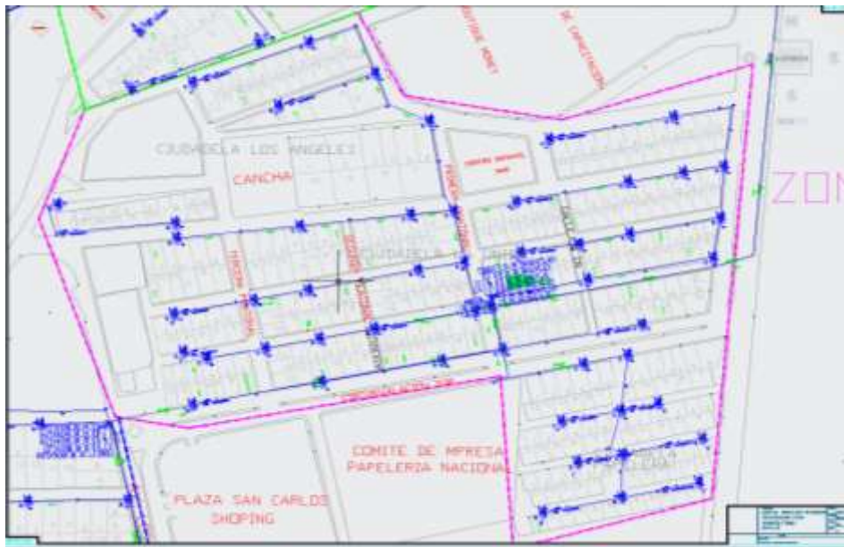
Figura No. 3.15 Distribución de las Cajas NAP en la zona 3 Elaborada por el autor
