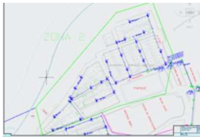
Figura No. 3.14 Distribución de las cajas NAP en la zona 2 Elaborada por el autor
