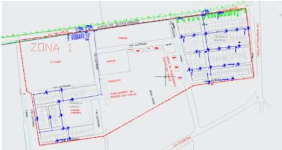
Figura No. 3.13 Distribución de las Cajas NAP en la zona 1 Elaborada por el autor
