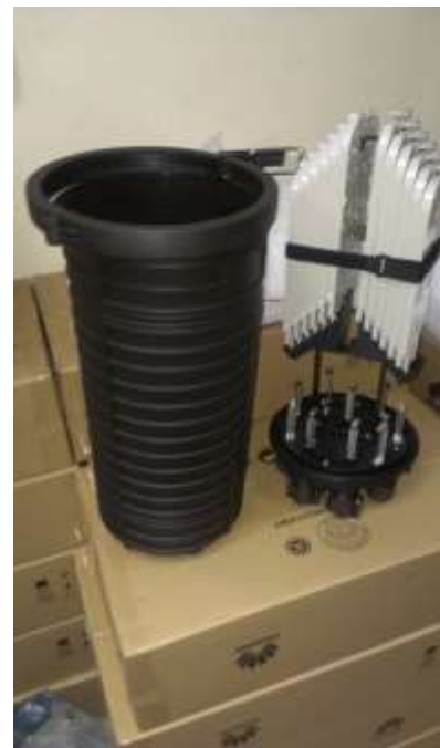
Figura No.4.3: Fotografía de una Manga subterránea de 288 hilos Elaborada por el Autor
