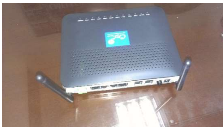
Figura No.4.1: Fotografía de una ONT utilizada por la CNT en última milla GPON
