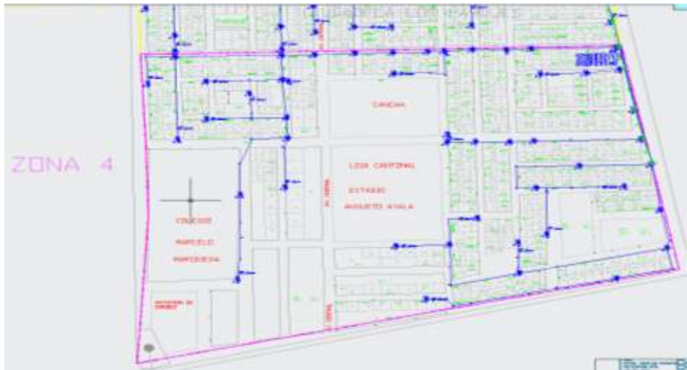
Figura No. 3.16 Distribución de las NAP en la zona 4 Elaborada por el autor
