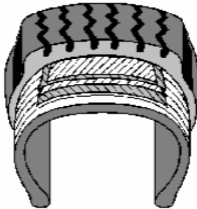
Figura 4 Diseño del neumático radial
