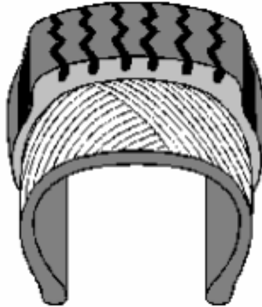
Figura 3 Diseño del neumático convencional
