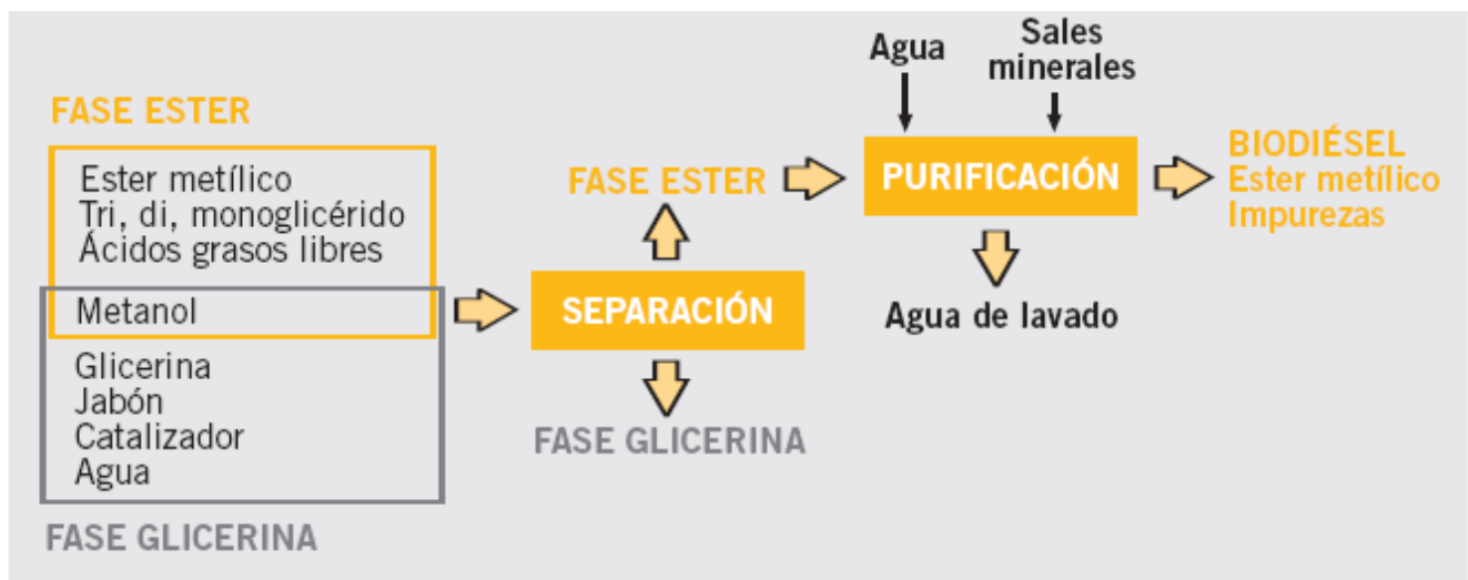
GRAFICO 17. Esquema de los procesos de separación y purificación del biodiesel
