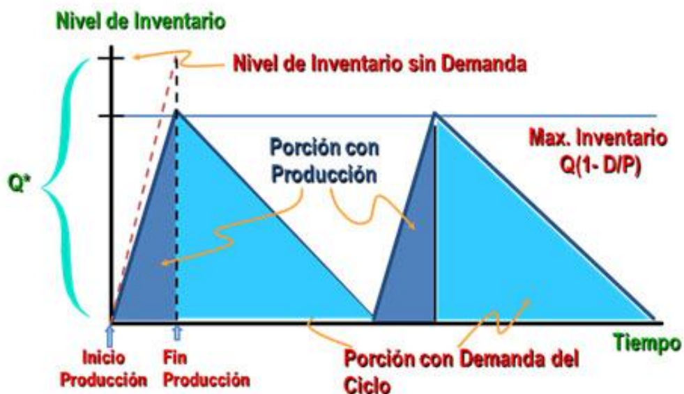
Gráfico No.18 Evolución del nivel de inventarios en función del tiempo Elaborado por: Andrea Estefanía Medranda Barahona y Freddy Alberto Prado Prado
