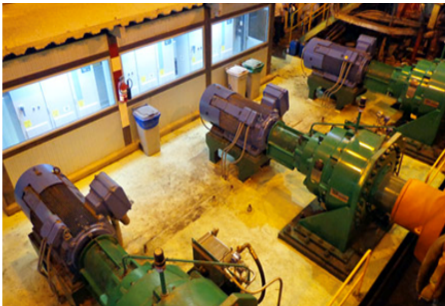
Figura 7. 3 Motores eléctricos Weg que dan movimiento a los molinos de los trapiches en el ingenio San Carlos Fuente: Omaconsa (2013)
