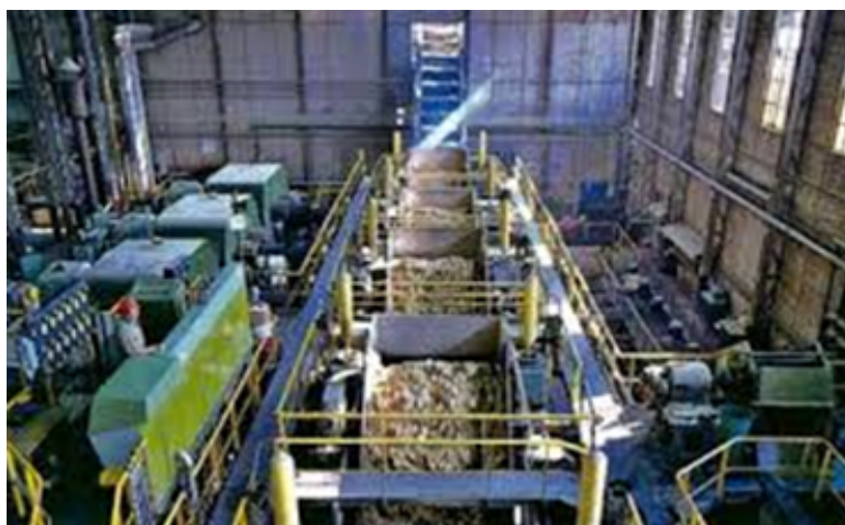
Figura 5. 5 Trapiche con cuatro molinos de extracción de jugo de caña de azúcar. Fuente: Productos de la caña (2012)
