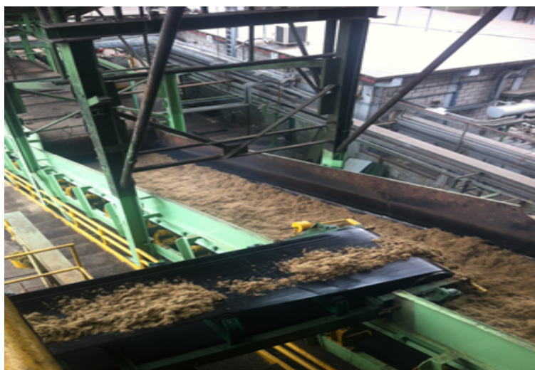
Figura 4. 7 Bagazo de caña de azúcar, movido por bandas transportadoras del Ingenio San Carlos Fuente: El Autor (2013)
