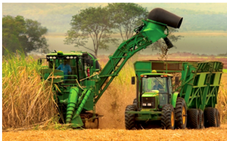
Figura 5. 4 Cosechadora realizando corte mecanizado de caña de azúcar Fuente: Revista El Pregón (2013)
