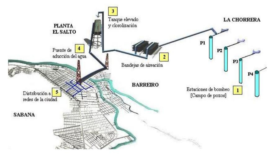
**Figura 17.** Esquema del Sistema de Agua potable de la ciudad de Babahoyo. Fuente: EMSABA (2012). Esquema del sistema de Agua potable [Gráfico]. Archivo de la compañía.
