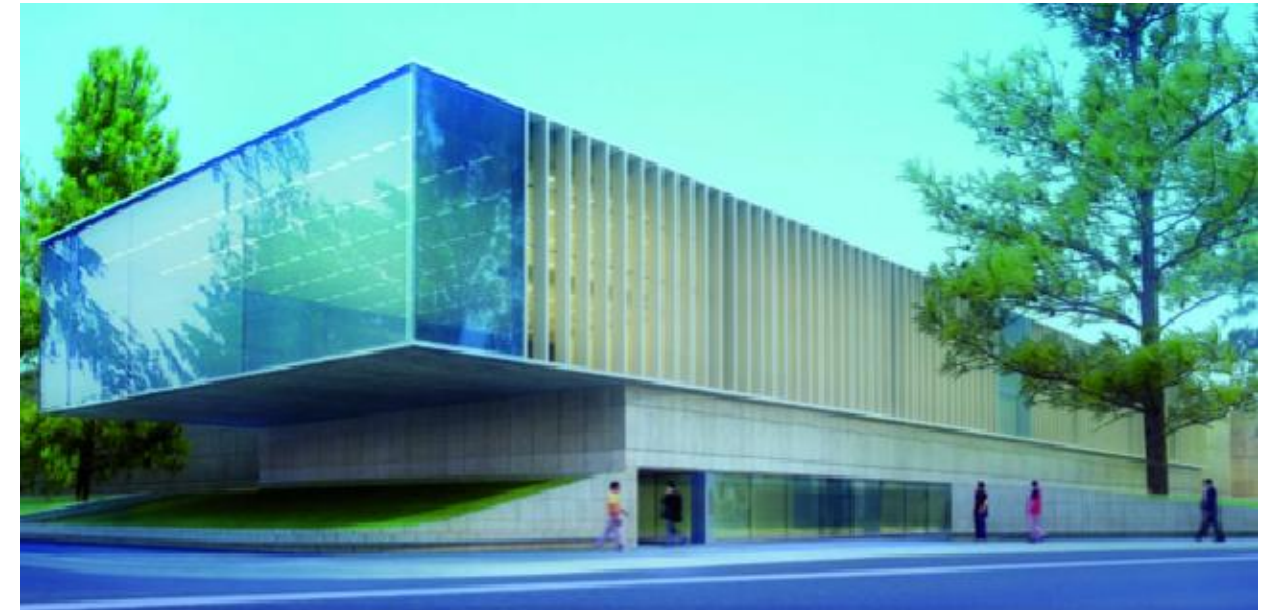
Figura 43. Planos verticales con protección solar Fuente: Comunidad de Arquitectura y Diseño, 2014
