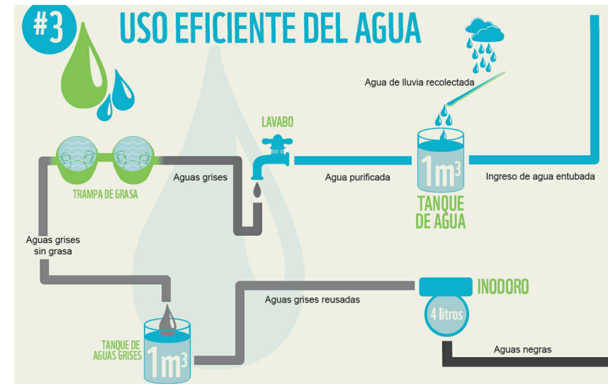
Figura 62. Uso eficiente del agua Fuente: WWF Ecuador, 2014
