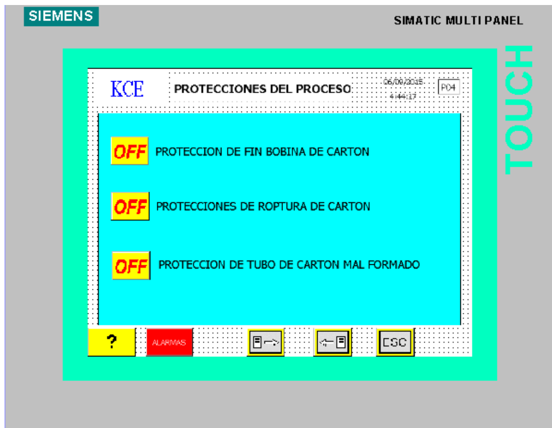
Figura 4.34. Pantalla de protecciones del proceso
