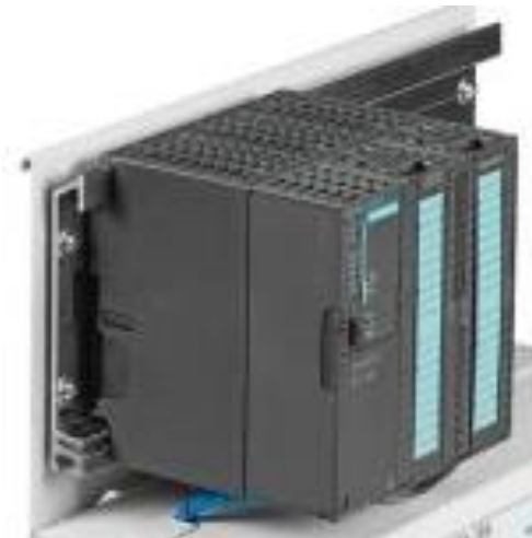
Figura 3.16 Rack de conexión del PLC
