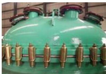
Ilustración 14: Reactor, Parte superior
