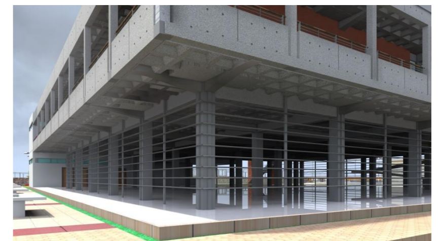
Figura 11. Por seguridad se planteó crear un cerramiento con quiebrasoles de aluminio
