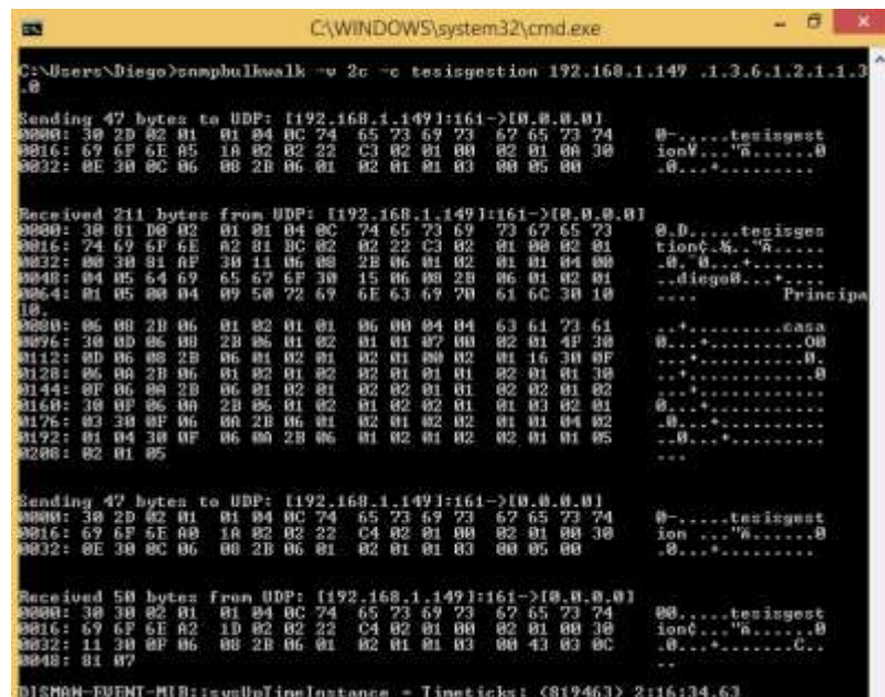
Figura 4.16 Configuración del comando SNMPBULKWALK, a diferencia del snmpwalk solo se cambia el comando.
