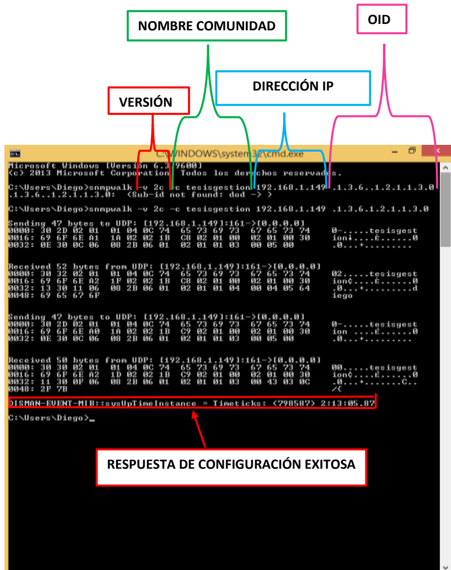
Figura 4.12 Configuración en CMD del comando SNMPWALK desde la máquina gestora. Elaborado por: Autor
