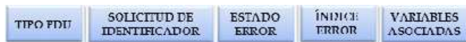
Figura 2.17 Formato de las PDU informRequest, Report y Trap v2 Fuente: (Moreno & Serna, 2013)
