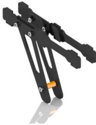
Figura 3. 2: Tren de aterrizaje armado y listo para unirse al cuerpo (x3). Fuente: (Robotshop).
