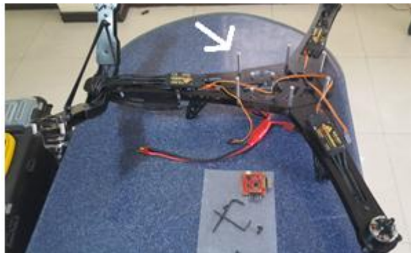
Figura 3. 17: Adaptación de tarjeta multiwii en estructura de quadcoptero Fuente: Autores
