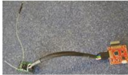
Figura 3. 24: Conexión entre el RC y la tarjeta multiwii. Fuente: Autores.
