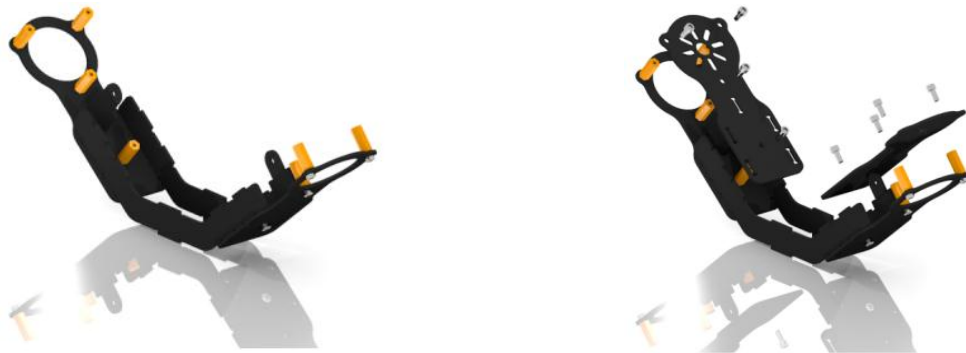
Figura 3. 5: Armado de la cola trasera del cuadricoptero. Fuente: (Robotshop).
