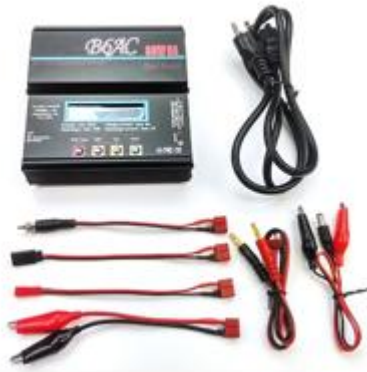
Figura 2. 28: Cargador inteligente de batería con sus respectivos cables. Fuente: (Lynxmotion, Robotshop, 2015).
