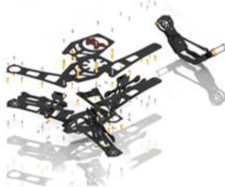
Figura 3. 9: Unión de todas las partes del quadcoptero. Fuente: (Robotshop).
