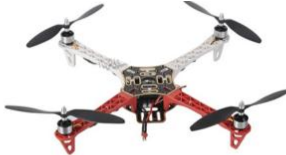
Figura 2. 1: Cuadricoptero con cuatro brazos. Fuente: (Olimex, 2015).
