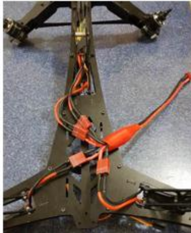
Figura 3. 16: Cables de alimentación se conecta a cada ESC. Fuente: Autores.
