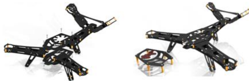
Figura 3. 10: Armado completo del cuerpo del quadricoptero modelo V-tail 500. Fuente: (Robotshop).
