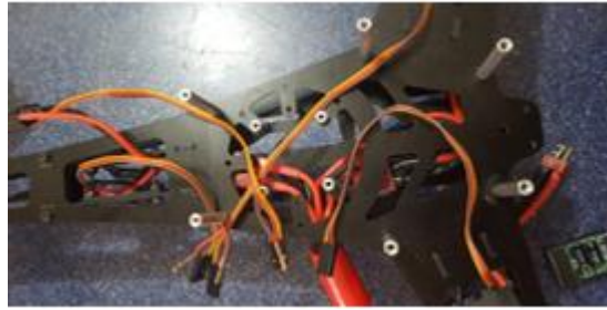
Figura 3. 21: Cables rojos de los ESC retirados, solo queda 1 con el cable rojo. Fuente: Autores.
