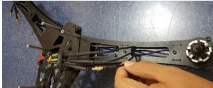
Figura 3. 13: Instalación del controlador electrónico de velocidad (ESC). Fuente: Autores.
