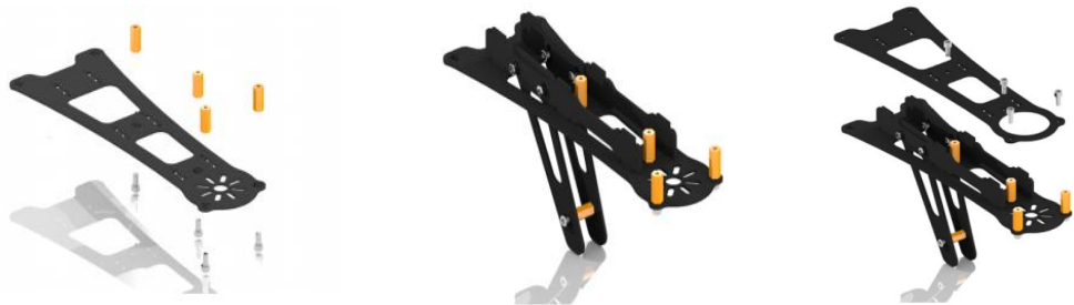
Figura 3. 3: Ubicación de los tornillos y separadores hexagonales. Fuente: (Robotshop).
