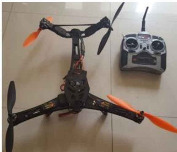
Figura 3. 37: Terminado el armado del cuadricoptero con la tarjeta Quadriano nano. Fuente: Autores.
