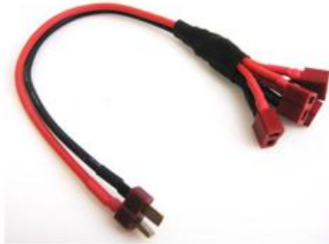
Figura 2. 26: Cables de distribución de energía. Fuente: (Lynxmotion, Robotshop, 2015).
