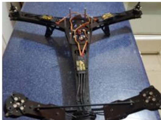
Figura 3. 14: Instalación de los 4 ESC con los motores. Fuente: Autores.
