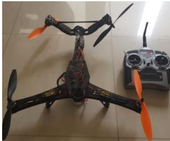
Figura 3. 29: Terminado el cuadricoptero V-tail 500.
