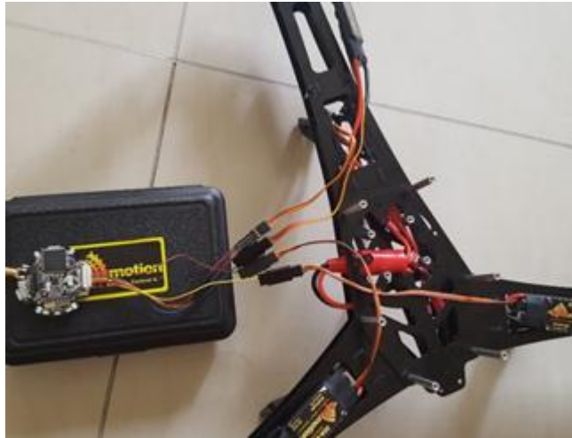
Figura 3. 31: Conexión de la quadrino a cada uno de los CES de los motores. Fuente: Autores.
