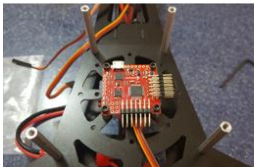
Figura 3. 19: Tarjeta multiwi colocada en la infraestructura del dron
