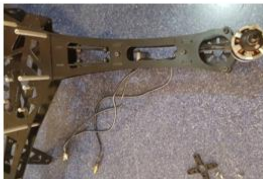
Figura 3. 11: Instalación de motor brushless en el quadricoptero. Fuente: Autores.
