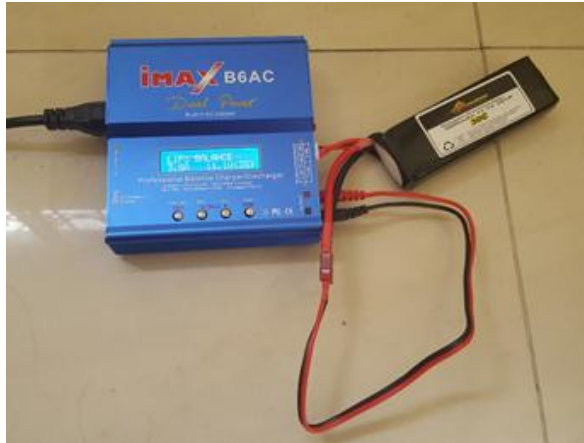
Figura 3. 38: Cargando batería Lipo de 3.8 mA. Fuente: Autores.
