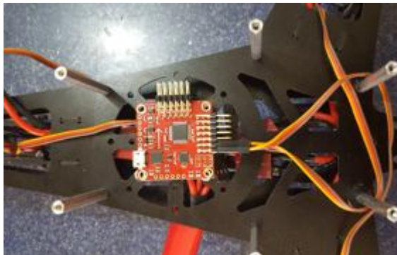
Figura 3. 22: Cables de los CES en la tarjeta multiwii. Fuente: Autores.
