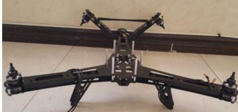
Figura 3. 12: Montaje de los 4 motores brushless en el cuadricoptero. Fuente: Autores.
