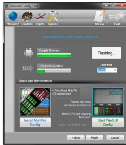
Figura 3. 35: Flasheando la información al controlador Quadriano Nano. Fuente: Autores.
